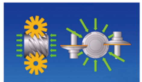
축(shaft)부하와 방사형(radial)부하의 평형으로 베어링의 부하, 소음, 진동이 작다.
