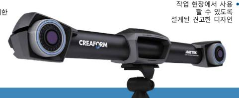
HandyPROBE Next 와 MetraSCAN 3D 시스템에 포함된 **C-Track** 옵티컬 트래커는 HandyPROBE, MetraSCAN 3D, 포지셔닝 타겟의 위치를 실시간으로 트래킹하는 다이내믹 레퍼런싱을 수행하며, 이는 Creaform 옵티컬 CMM의 핵심 기능입니다. 최신의 고품질 부품으로 만들어진 **C-Track**은 전체 시스템의 최고의 정확도를 보장합니다.
