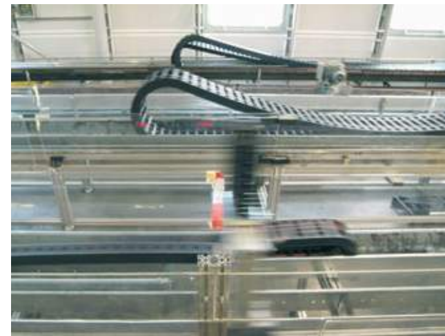
10m/s 이상의 압축 인장 속도 및 200m/s² 이상의 가속도 시험
