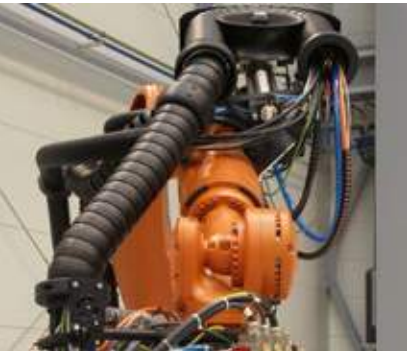
로봇 암에 적용된 RS시스템과 CF ROBOT케이블
