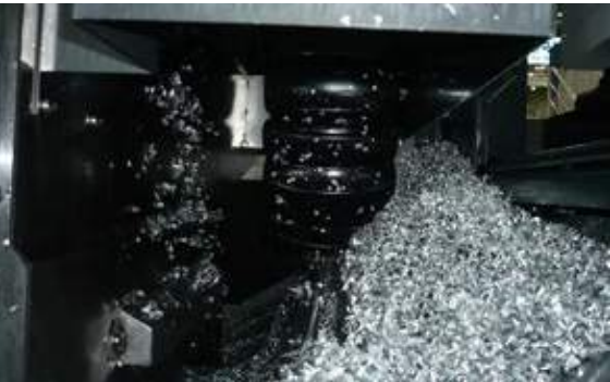
공작기계 사용시 발생하는 칩이 쌓이지 않는 타원형 디자인의 e체인 RX-tube
