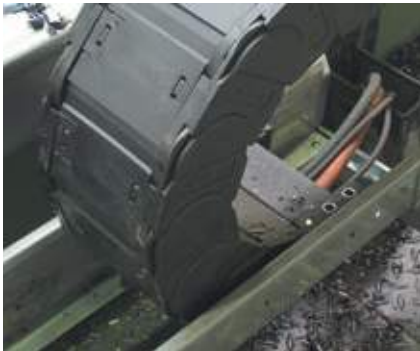
특수 소재 igumid HT를 포함, 완전 밀폐형 E4 e튜브를 설치한 전용 밀링기. 850°C 고온의 칩 환경에도 적용가능
