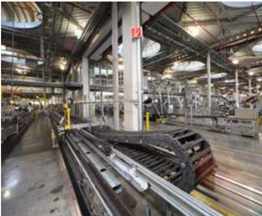
e체인, chainflex®케이블 테스트 장비
