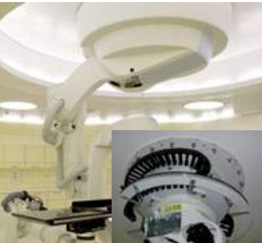
천정 부착형 X-ray 로봇에 적용된 twisterchain® 과 chainflex® 케이블
