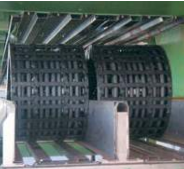
석탄 하역용 쉽 로더(ship loader)에 사용된 확장 링크를 포함한 E4 시리즈.
