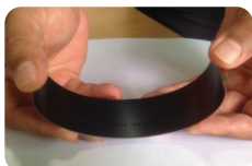
이 사진은 100,000회 ON/OFF 시험후 레디알 베어링의 표면을 찍은 사진입니다.
