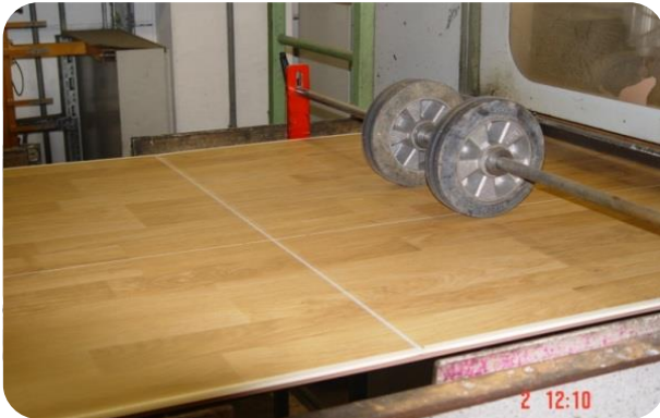
라미네이트 바닥 광택 측정
