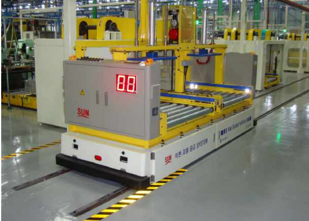
In-Out Let Lifter(3 ton) – 승,하강 Motor 구동방식(다단속)
