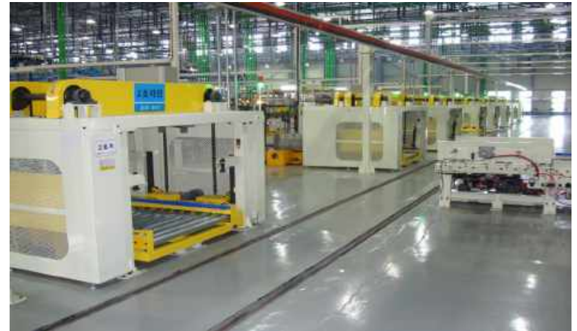
In-Out Let Lifter(3 ton) – 승,하강 Motor 구동방식(다단속)
